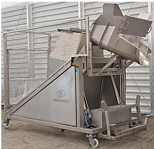
Загрузочное устройство тележек предназначено для перегрузки сырья из EUROBOX непосредственно в оборудование массажер типа МАН. Пространство, в котором поднимается груз, полностью изолировано от машины во время транспорта защитной решеткой с датчиками.
